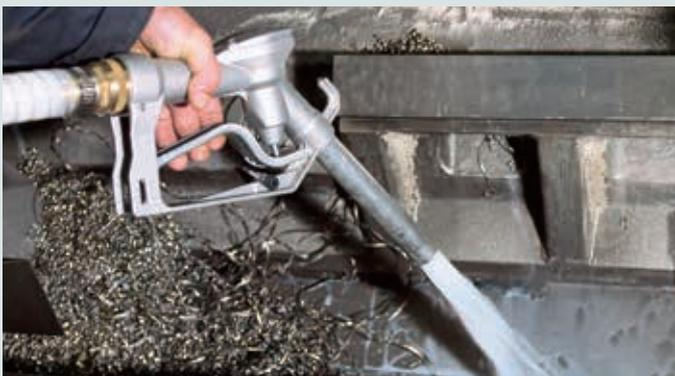
Zurückpumpen von Ölen in die Bearbeitungsmaschine
